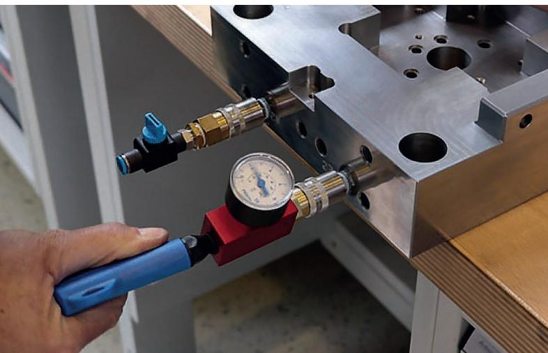
**Einfach zu handhaben:** das patentierte Druckluft-Tool, mit dem unter anderem Temperierkanäle auf Dichtigkeit geprüft werden können, um Leckagen frühzeitig zu erkennen © Nonnenmann
