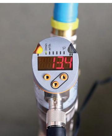
**Einfach zu interpretieren:** die digitale Anzeige am Messgerät, die den Durchfluss in Litern pro Minute exakt angibt © Nonnenmann
